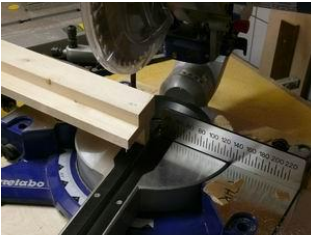
Schneiden der 10°- Gehrung am oberen Ende der Pfosten.
