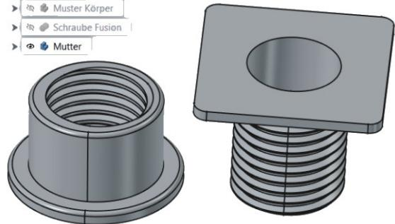
Da die Schraube als Differenz eines Zylinders und der Mutter erstellt wird ist keine Toleranz zwischen Innen- und Außengewinde vorhanden. Dies ändert man in dem im 3D-Druck-Slicer die Mutter skaliert wird.
