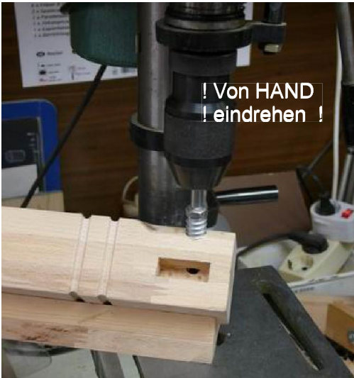
Einsetzen der Rampamuffen.
