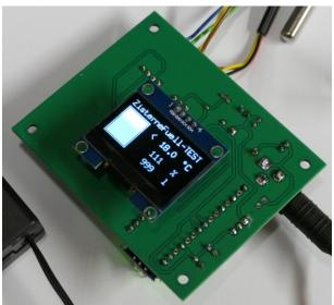
Für den Einbau in ein Gehäuse kann das Display auf der Leiterbahnseite gesteckt werden.
